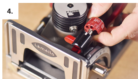
4. Per la regolazione estrarre il regolatore di profondità P-System e ruotarlo su «Off»
