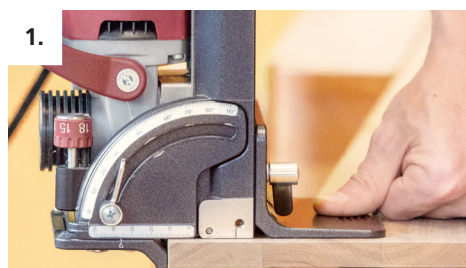
1. Fresare la scanalatura per P-System con la regolazione P-14
