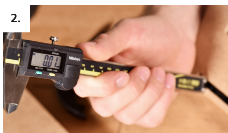
2. Inserire le metà delle giunzioni P-14 e misurare la rientranza
